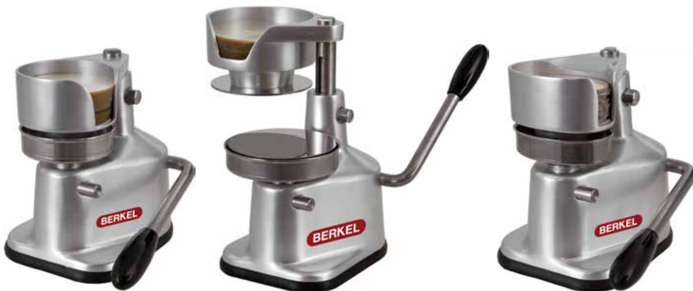
IT - Formatrice per hamburger ideale per ristoranti e macellerie. Pressa realizzata in alluminio anodizzato, parti a contatto con la carne in acciaio inox smontabili senza attrezzi. Apertura automatica laterale del pressore. Spinta in alto dell'hamburger per facilitarne l'estrazione.
