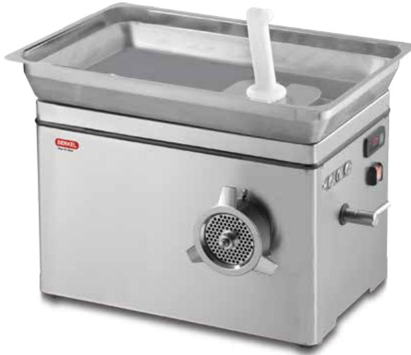
IT - Tritacarne refrigerati dedicati a laboratori, catene di supermercati ed ipermercati. Corpo in acciaio inox AISI 304 completamente saldato e sabbiato, pulsantiera di comando inox IP67, impianto refrigerante con Gas R134 e refrigerazione su collo, bocca e tramoggia.
