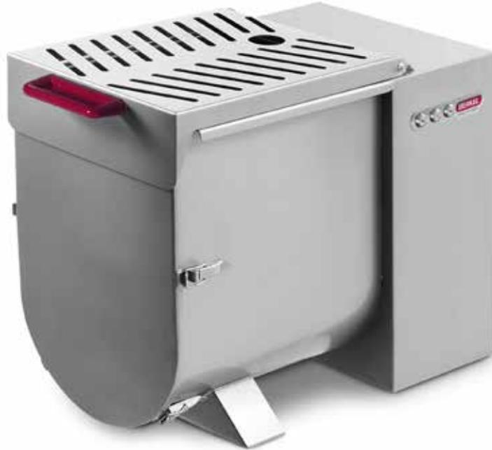
IT - Mescolatore professionale da banco monoalbero e monopala, ideale per negozi retail. Corpo, coperchio con micro di sicurezza e pala in acciaio inox Aisi 304, riduttore a bagno d'olio e sistema di protezione ingranaggi con doppio paraolio. Sportello vasca apribile per rimozione pala e impasto, comandi in acciaio inox IP67.
